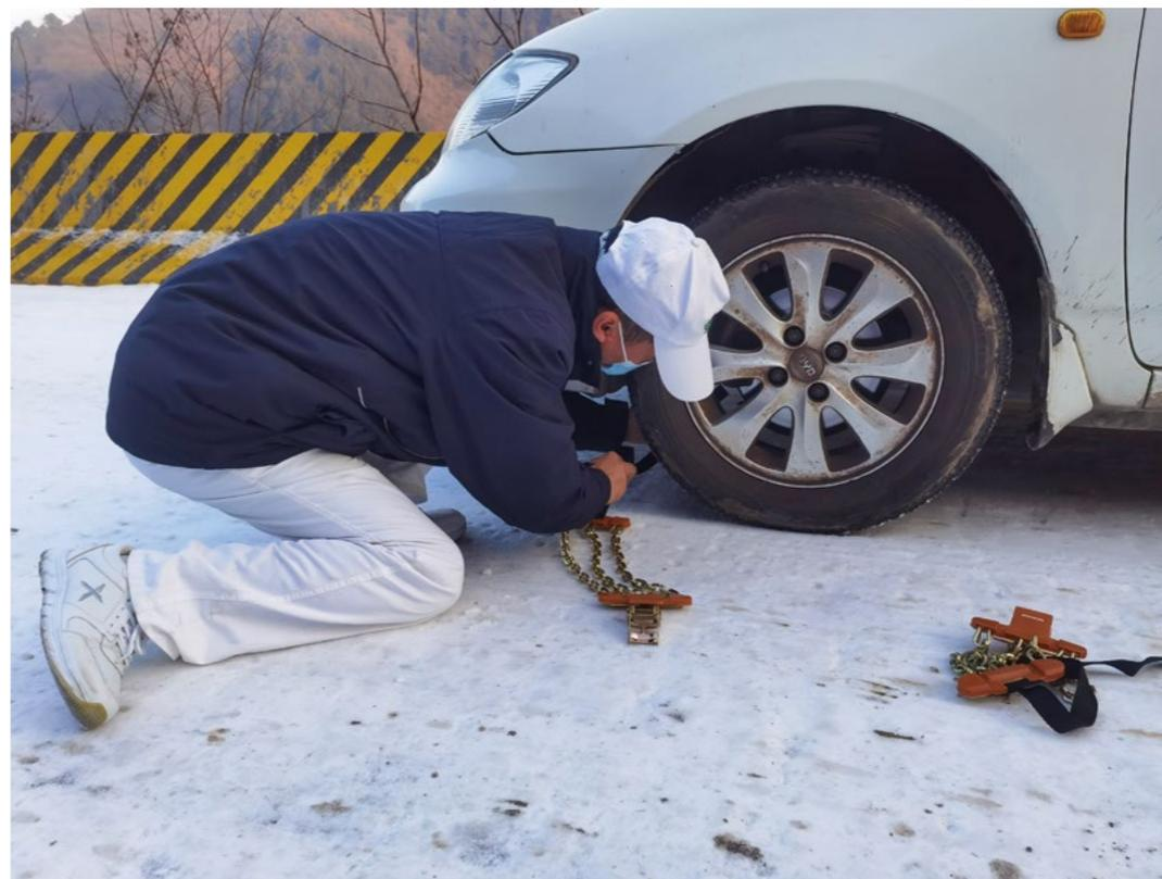
山区弯路多，坡度大，路面冰雪还未融化。为了安全，志工给每个车轮缠上防滑链，增加车辆下坡、转弯的阻力。摄影/王秦
